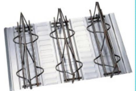
汉德邦建材钢筋桁架楼承板是将楼板中钢筋在工厂加工成钢筋桁架，并将钢筋桁架与镀锌压型钢板焊接成一体的组合模板；其广泛应用于单层、多层、高层钢结构及混凝土结构建筑；具有技术领先、施工快捷，抗震、防火、防腐性能好，质量稳定、安全可靠、板底平整、美观环保、选材经济、综合造价低、板型丰富等优点。
